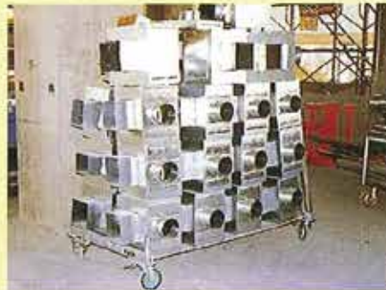
ダクト(チャンバー)のストックヤード
